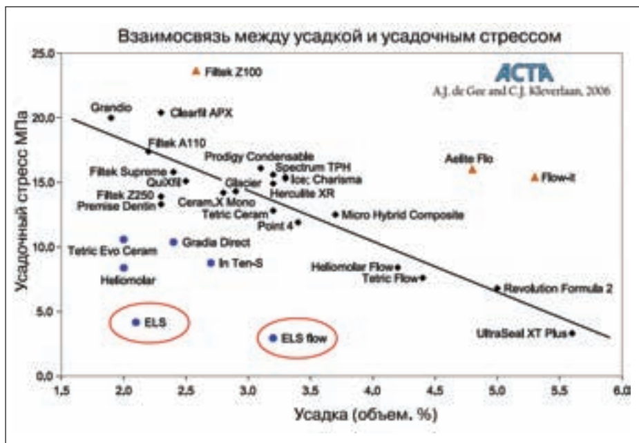
■График 2. Взаимосвязь между усадкой и усадочным стрессом в процессе полимеризации. Для 21 из протестированных материалов (♦) наблюдается высокая корреляция ( r^2=0,81 ) между усадкой и возникающими напряжениями; — низкая усадка вызывает значительные напряжения и, наоборот, 9 материалов (● и ▲) не следуют этому закону. Расположенные ниже линии корреляции (●) имеют более низкие значения усадки, или стресса, чем находящиеся на линии (♦) или выше нее (▲)
